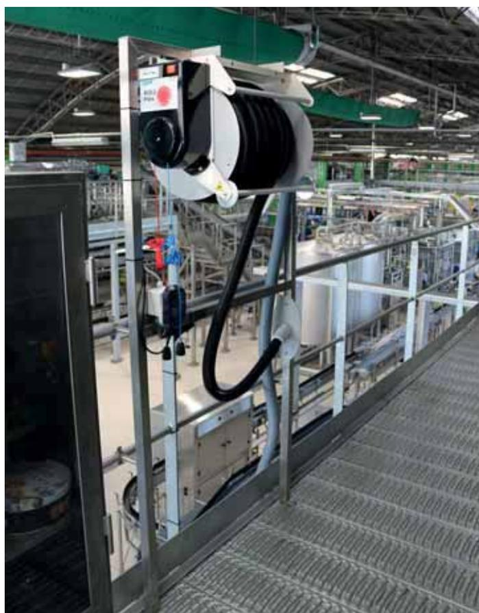
Roll Flex è l'evoluzione del tradizionale avvolgiore a parete con sistema motorizzato per lo svolgimento/arrotoamento, è robusto e progettato con componenti meccaniche ed elettriche, studiate per resistere a numerosi cicli di utilizzo.
